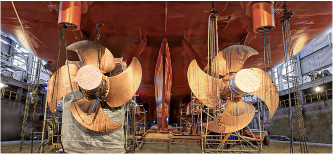
Im Bau: zwei SCHOTTEL ControllablePropeller Typ SCP 1294 mit je 9.600 kW für die Ro-Ro-Fähre Tennor Ocean bei der Flensburger Schiffbau-Gesellschaft (FSG)
